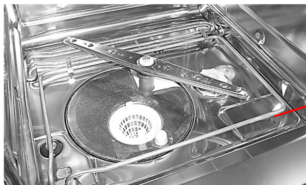
Fig. 11. Vista indicativa del interior de la cámara de lavado, detalle de las resistencias de calentamiento.
